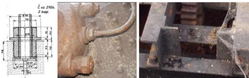
Napojení mazacího potrubí na ložiska, mazací hlavice na zdvihadle
