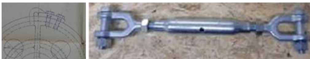
Stávající spona řetězu na zdvihadle a napínací šroub s vidlicemi
